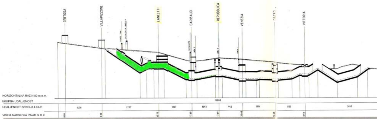
Slika 4. Uzdužni presjek linije Passante Ferroviario s označenim dionicama na kojima se iskop obavlja TBM-om [4]
