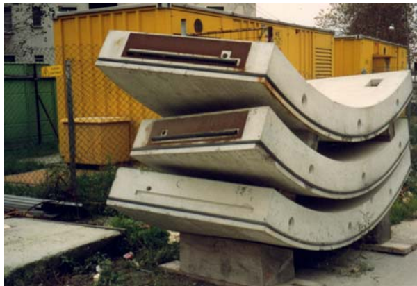
Slika 10. Pojava pukotina na rubnim dijelovima segmentne obloge nakon montaže segmenata te uzdužna reška poboljšana ugradnjom čeličnih ploča [7]
